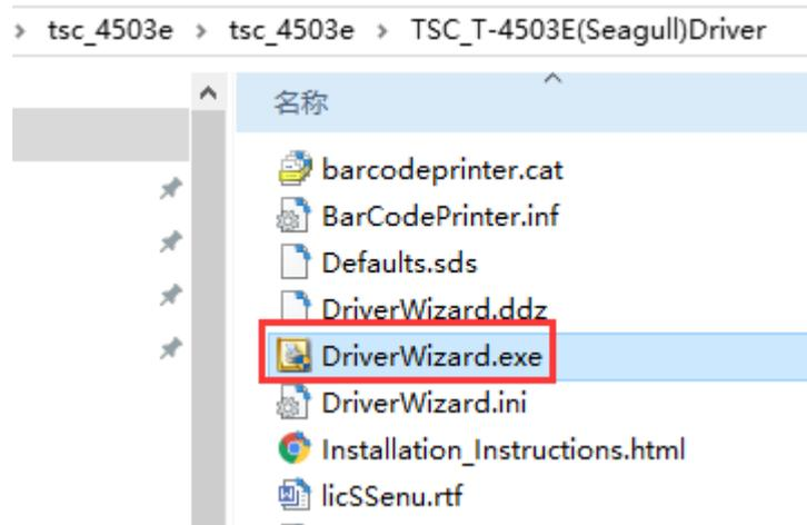
安装驱动，打印机需要先开机，并通过 USB 链接电脑 USB 接口
